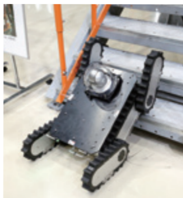
楡葉遠隔技術開発センターモックアップ階段での試験
